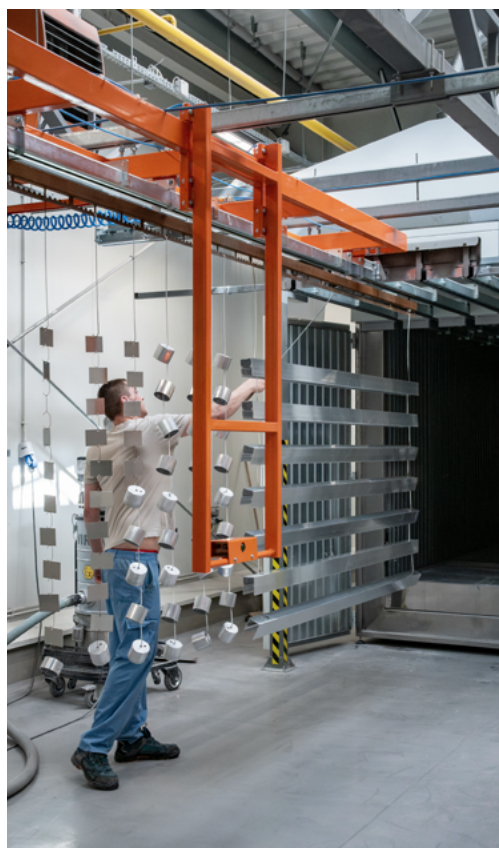
Fot.5. Przedstawienie niskowysiłkowego procesu wkładania partii produkcyjnej do pieca, dzięki szynowemu systemowi transportu.
