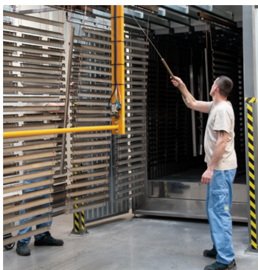
Fot.6. Proces wypalania partii produktowej w nowym piecu w zakładzie produkcyjnym.
